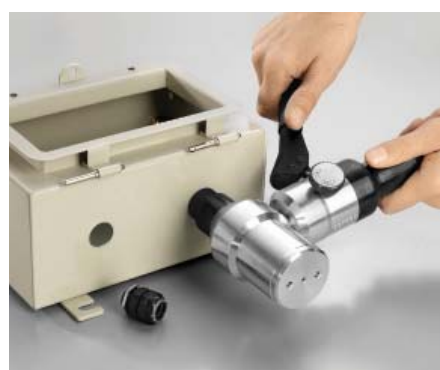
С помощью гидравлического пробойника для отверстий в листовом материале выполняются точные отверстия для кабельных вводов с метрической резьбой и резьбой PG.
