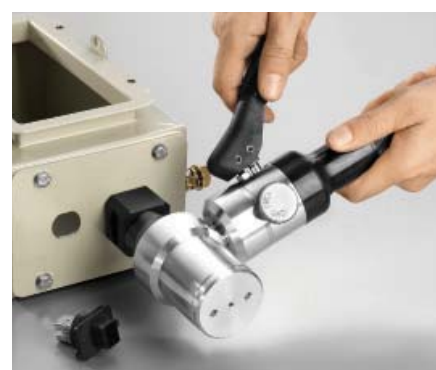
Вырубка отверстий для различных соединителей промышленной сети Ethernet.
