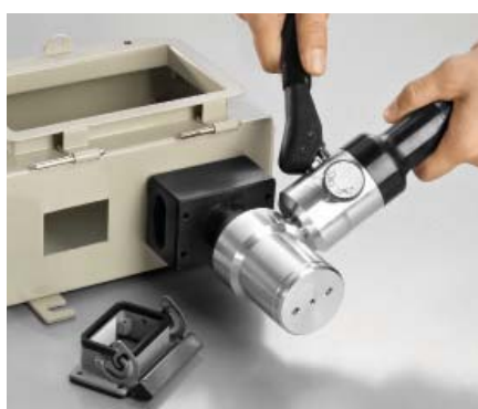
Автоматическая разметка при помощи клеймения в месте, где предусмотрено отверстие под промышленные разъемы.
