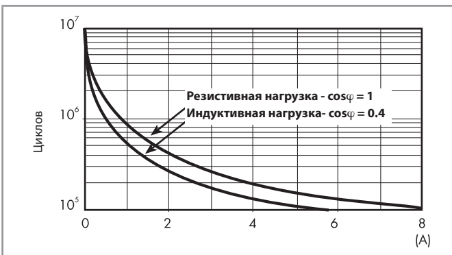
F 48 - Электрическая долговечность (AC) при ном. нагрузке, Типы 48.P5/52
