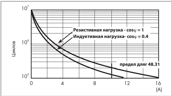
F 48 - Электрическая долговечность (AC) при ном. нагрузке, Типы 48.P5/52
