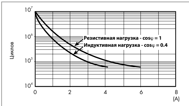
F 39 - Электрическая долговечность (AC) при ном. нагрузке
