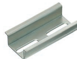
TS 35/15 мм согласно EN 50022 (s = 1.5 мм)
