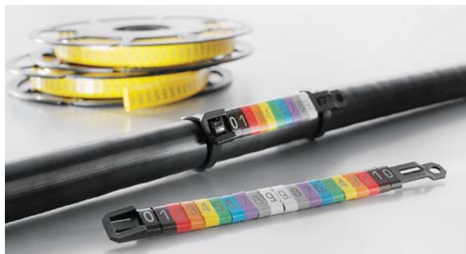
Маркеры типа CLI M надеваются на фиксирующие полосы типа CLI MH и окончательно монтируются с помощью кабельных стяжек.
